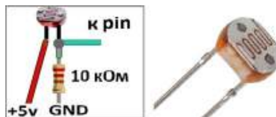
Рис. 4. Схема подключения фоторезистора к Ардуино
